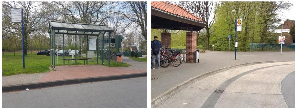
Nur einzelne Bushaltestellen verfügen über Hochborde und Leitstreifen. Die Beispiele Coesfeld Bahnhof und Lüdinghausen Busbahnhof zeigen einen barrierefreien Ausbau von Haltestellen nach dem aktuellen Stand der Technik.
