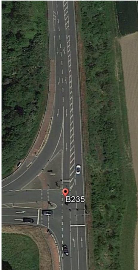
Abbildung 107: Beispiel für freien Rechtsabbieger, der nicht durch LSA gesichert wird (B 474 / L 600 / K 44 nordwestlich von Dülmen)
