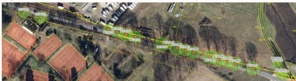
ABB. I. 2| PLAN MIT DEN GEGENSTÄNDLICHEN BÄUMEN. GRAFISCHE DARSTELLUNG DER KRONENTRAUFE<sup>1</sup> UND DER RECHNERISCHEN ABSTÄNDE BAUMSCHUTZBEREICH 4-FACHER STAMM-Ø UND STATISCH RELEVANTER BE- REICH IN ROT IN TIM-ONLINE.NRW.DE (18) WMS NW ALKIS © GEOPORTAL.NRW, 2023, © BASEMAP.DE / BKG, 2023
