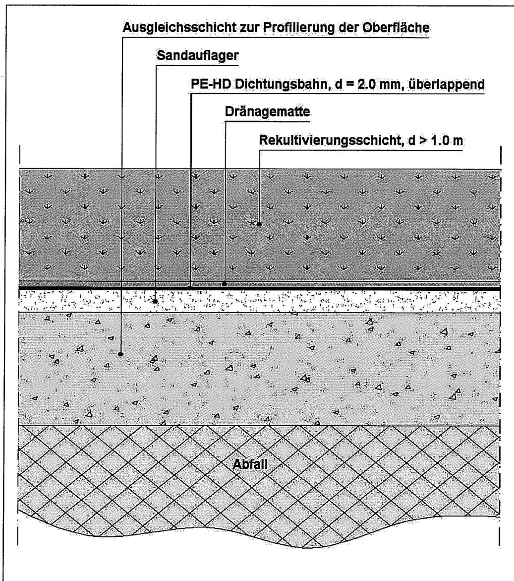
Abbildung 1: Aufbau der Oberflächenabdichtung
